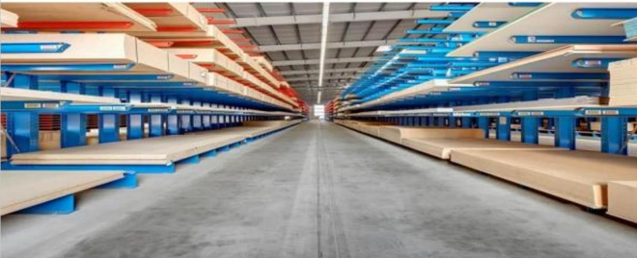
Le cantilever est la solution optimale pour le stockage horizontal de charges longues. Les structures robustes sont conformes à l'Eurocode III (calcul des structures en acier) et aux recommandations de la FEM 10.2.02.
